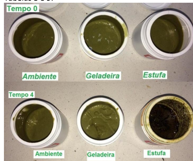
Figura 2. Verificação da estabilidade no tempo 0 e 4 do creme contendo 10% de Spondia sp.
