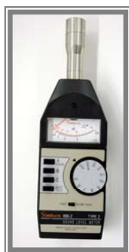
Figura 3. Decibelímetro mod. 886-2/890-2, cod. 00045, marca Simpson.
