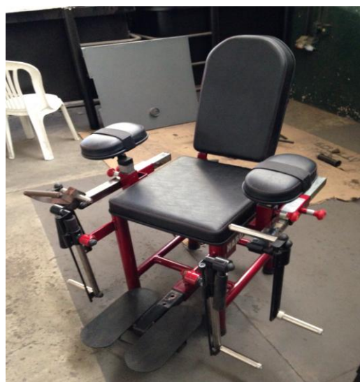
Figura 2. Aparelho para fortalecimento dos músculos do antebraço com sucatas em fase conclusiva de elaboração e construção.
