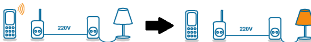
Figura 3. Funcionamento simplificado do protocolo X10.
