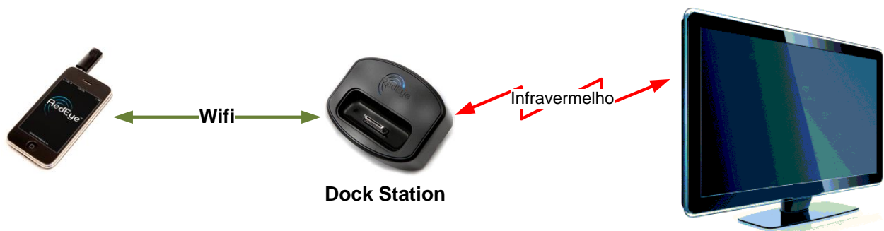
Figura 5. Funcionamento simplificado da tecnologia RedEye.
