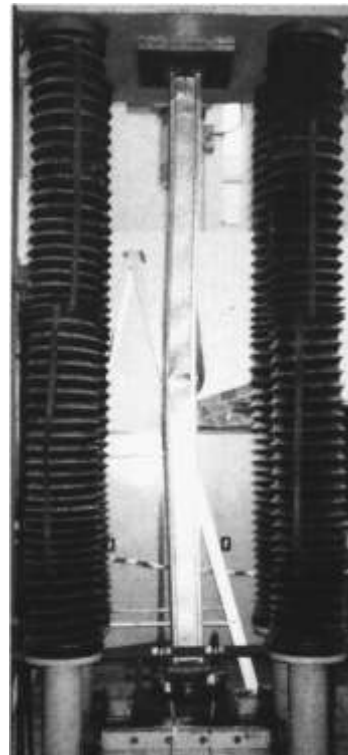
(b) Instabilidade local e por flexo-torção da barra T1.9F80L3000
