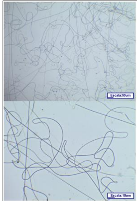
Figura 6. MO das nanofibras de rGO/PVA a 8%.
