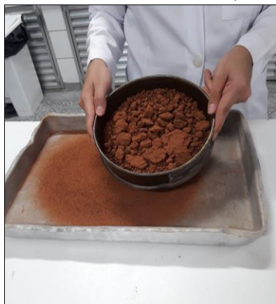
Figura 5. Peneiramento do solo em peneira nº 16.
