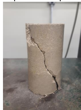
Figura 2. Corpo de prova solo-cimento após ensaio de compressão simples
