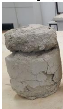
Figura 7. Corpos de prova com 3% cimento após o primeiro ciclo de molhagem/secagem
