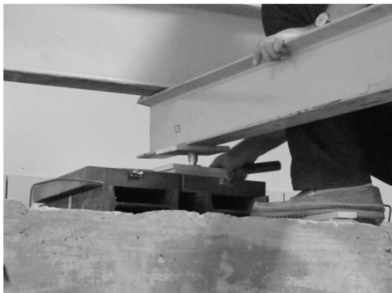
**Figura 12:** Pino de transferência de carga de uma das Vigas para Laje
