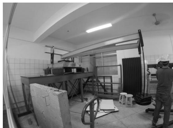
**Figura 11:** Mesa de reações com Protótipo
