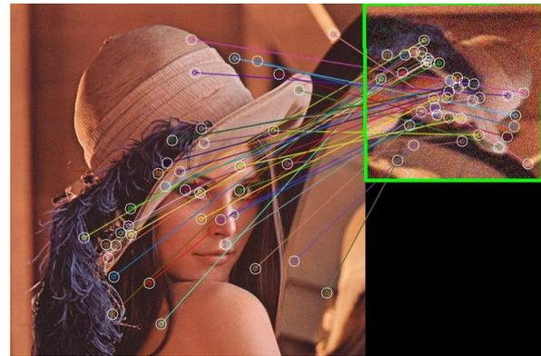
**Figura 9.** Resultado do algoritmo SIFT-SIFT que obteve o maior número de *inliers*, com um NIn = 44, o melhor e único resultado satisfatório entre todas as combinações dos algoritmos para a imagem (g) da Figura 4.
