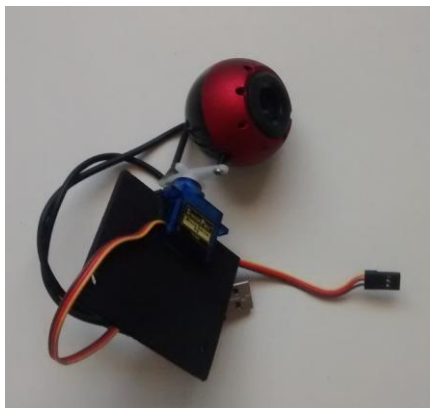
Figura 6. Webcam com servo em sua base.
